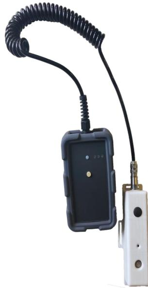
Co-développé avec Ellona, notre capteur portable et connecté, uDust, **identifie en temps réel** les quantités de poussières alvéolaires et la concentration de Silice Cristalline auxquelles sont exposés les travailleurs.
